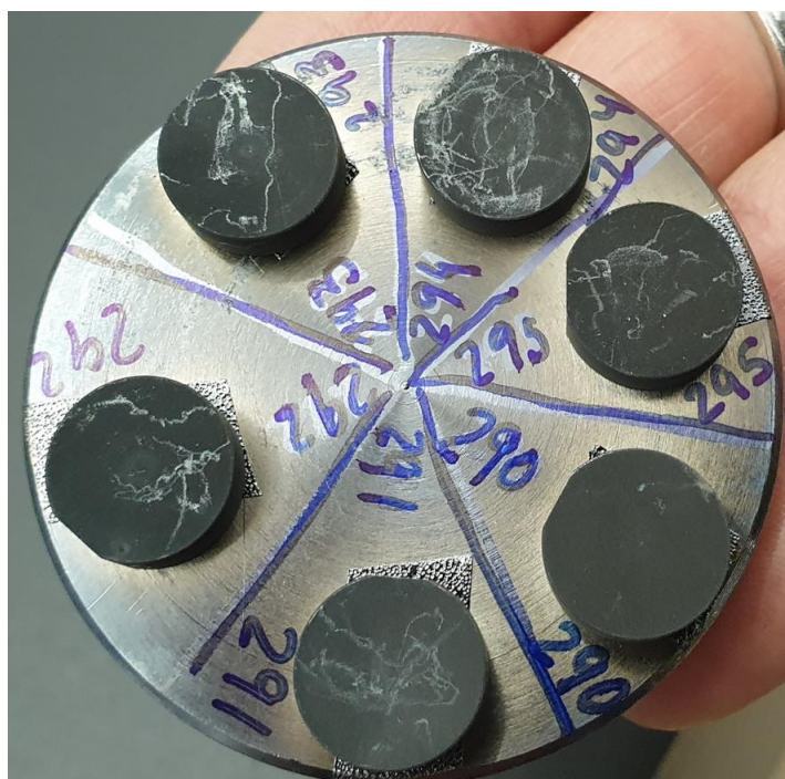
Figura 1: Discos de titanio, de 6 mm de diámetro y 2 mm de espesor, con el mismo acabado superficial Nanoblast plus® (Galimplant S.L., Sarria, España) de los implantes dentales Galimplant® (Galimplant S.L., Sarria, España)
