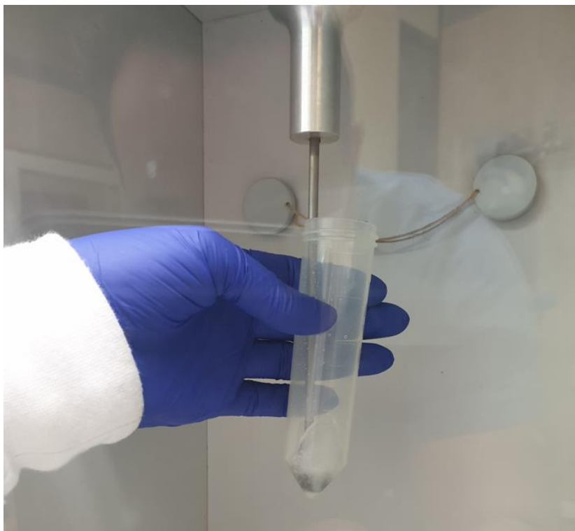
Figura 6: Tubo agitado sónicamente durante 30 segundos a una frecuencia de 50 Hz con el polvo de 150 W (Braun Labsonic ® , Braun Biotech International, Boston, EE. UU.)
