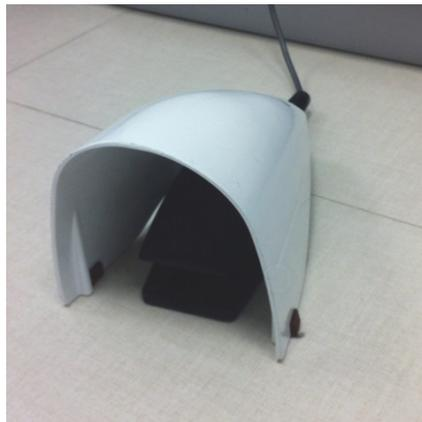
**Fig.3 Pedal de funcionamiento de LaserSmile™.**
