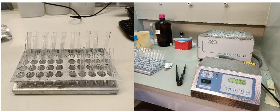
**Figura 4.7.** Tubos de cuarzo (izq.) y bloque térmico para la digestión húmeda (drcha.).
