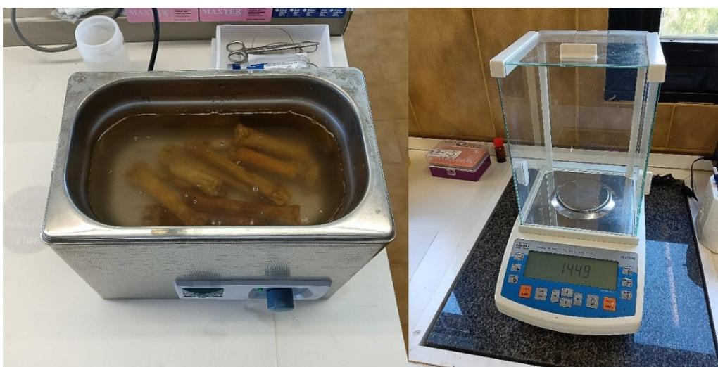
**Figura 4.6.** Máquina de ultrasonidos (izq.) y báscula de precisión (drcha.).
