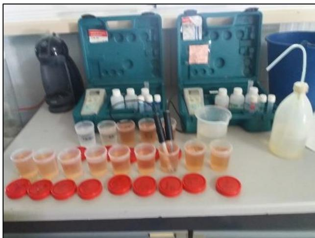
Imagen 3.5. Medición de parámetros de la SN de las cubas de riego.
