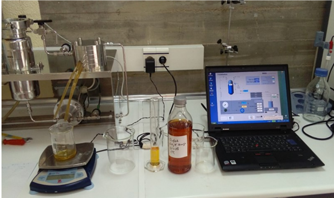
Figura 4.4. Imagen del equipo experimental utilizado en la realización de los ensayos de separación de azúcares mediante distintas membranas de ultrafiltración.
