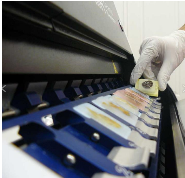
Figura 20. Colocación de los bloques tumorales donantes en el microarrayer automatizado TMA Grand Master (imagen extraída de la página web oficial del arrayer https://www.3dhitech.com/research/tissue-microarrays/tma-grand-master/ ).
