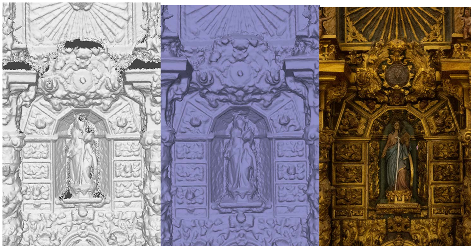
Figura 4 FASES DEL PROCESADO DE LOS DATOS DE UNA ZONA DEL RETABLO MAYOR DE EL BONILLO, DONDE APARECE EN A) LA NUBE DE PUNTOS OBTENIDA. B) LA MALLA TRIANGULAR GENERADA. C) EL MODELO CON LA TEXTURIZA
