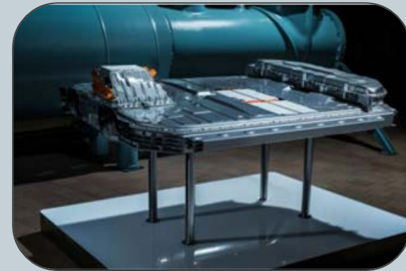
Figura 19- Módulo de batería NMC del Audi e-tron. https://as.com/motor/2019/04/23/mas_motor/1556024872_600863.html .
