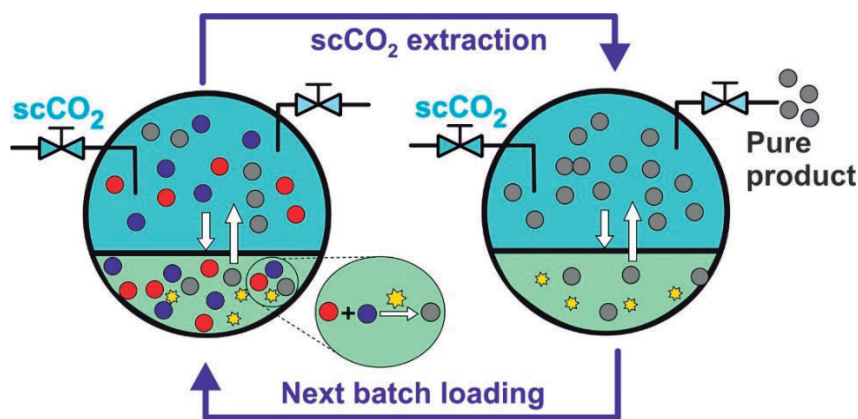
Figura 1.11. Esquema general para procesos de separación de reacción integrados en sistemas bifásicos LI / \text{scCO}_2
