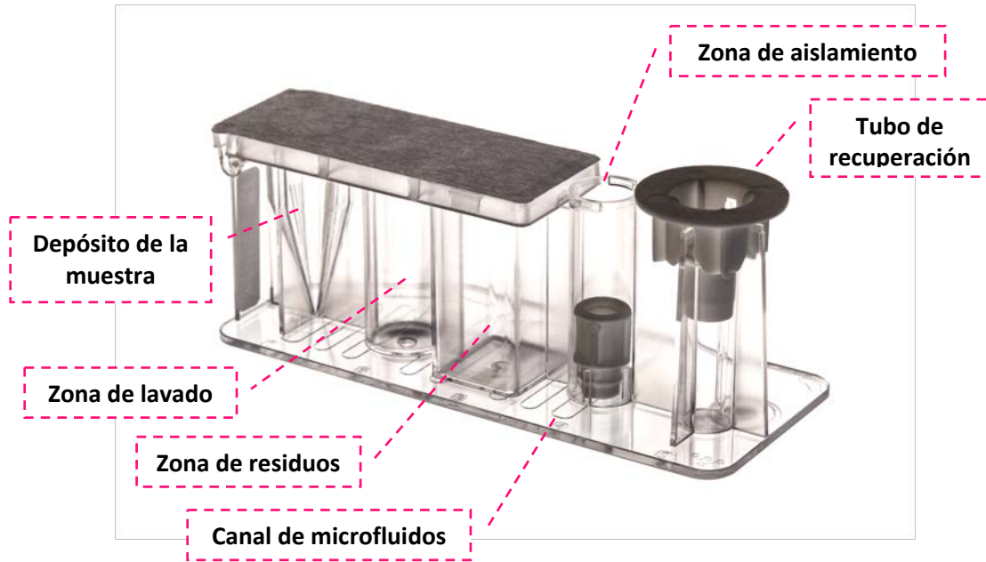
Figura 4. Cartucho del sistema Isoflux con sus diferentes depósitos. Adaptada de https://liquidbiopsy.fluxionbio.com/isoflux-ctc .
