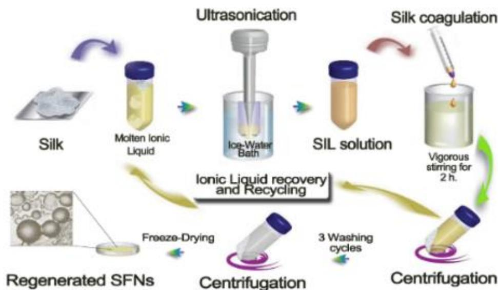
**Figura 2.8.** Esquema del proceso general de disolución de SF, utilizando IL y ultrasonidos, y la consiguiente preparación de SFN a partir de la disolución SF/IL [23].
