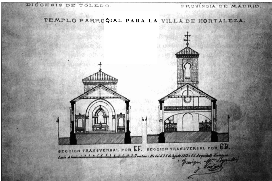
Figura 5. Iglesia de San Matías en Hortaleza (Madrid). 1877. Secciones transversales. A.M.J., leg. 3.743, exp. 11.533.
