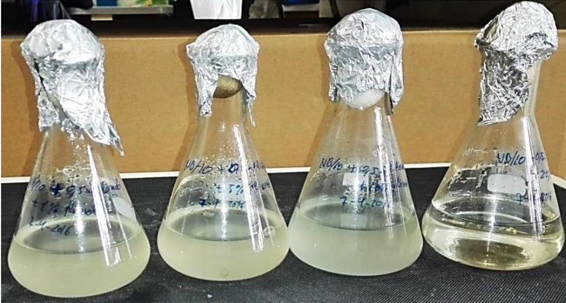
**Fig. 108.** Matracas tras el primer día de incubación; de izquierda a derecha: matraz con 50ml de medio NB-10 +1% de glicerol, con un 5% de glicerol, con un 10% y con un 20% de glicerol donde no se observa turbidez y, por tanto, crecimiento bacteriano alguno.
