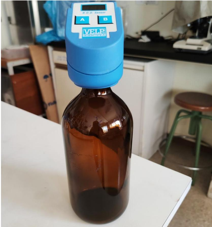
**Fig.19.** Frasco y manómetro, propios de la realización de la técnica de la DBO<sub>5</sub>, utilizados para contener el agua cruda recolectada de la fase de pretratamiento de la E.D.A.R. Base para la técnica AMS.
