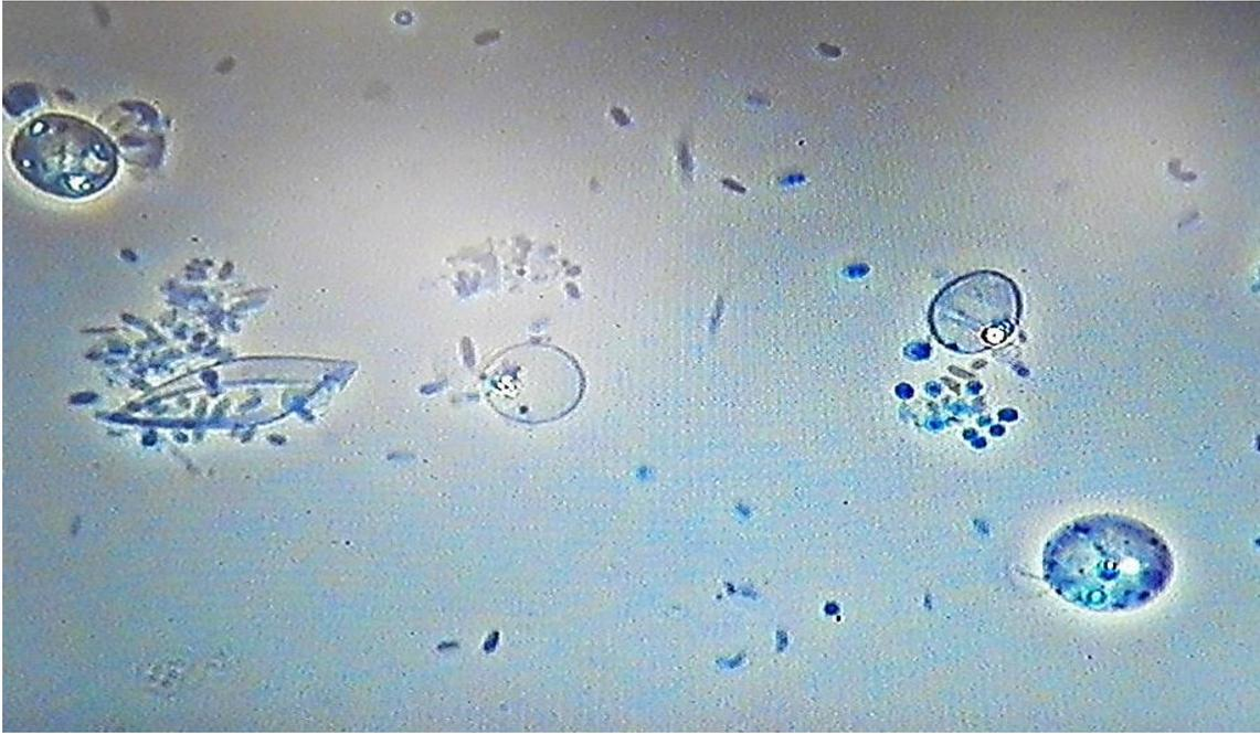
**Fig. 23.** Diversidad microbiana observada en la muestra de agua obtenida de la fase de pretratamiento del E.D.A.R. Observaciones realizadas en contraste de fase. Objetivo de 40x.
