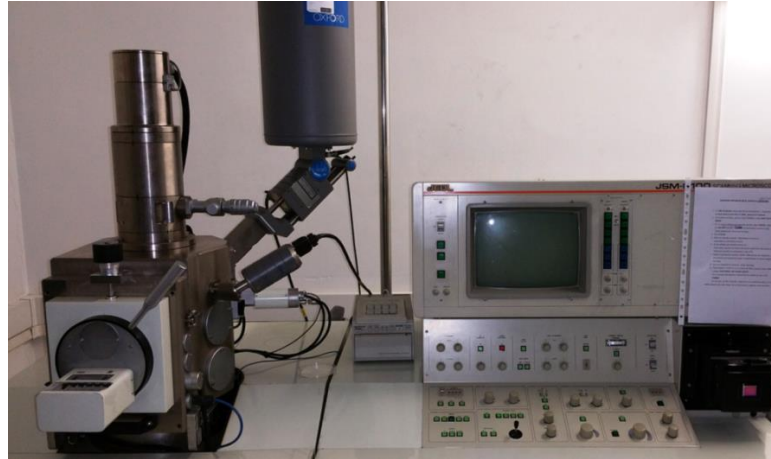
Figura 32. Microscopio de Barrido JEOL-6100 y sistema de Microanálisis por dispersión de Rayos X INCA de Oxford Instruments.
