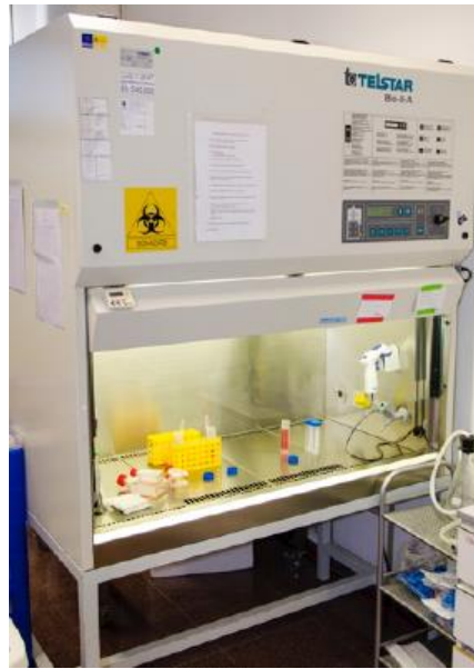
Figura 24. Cabina de seguridad biológica vertical tipo II con filtro HEPA (Telstar).
