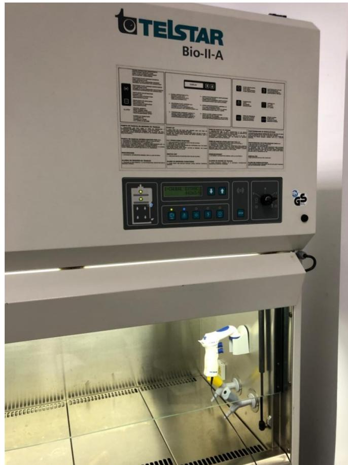
Figura 10: Cabina de seguridad biológica vertical tipo II con filtro HEPA (Telstar)
