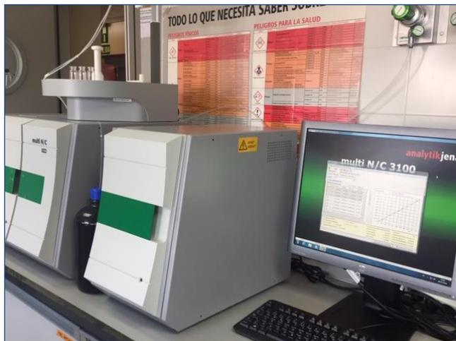
Figura 3.3.-Analizador de Carbono Orgánico total en muestras líquidas
