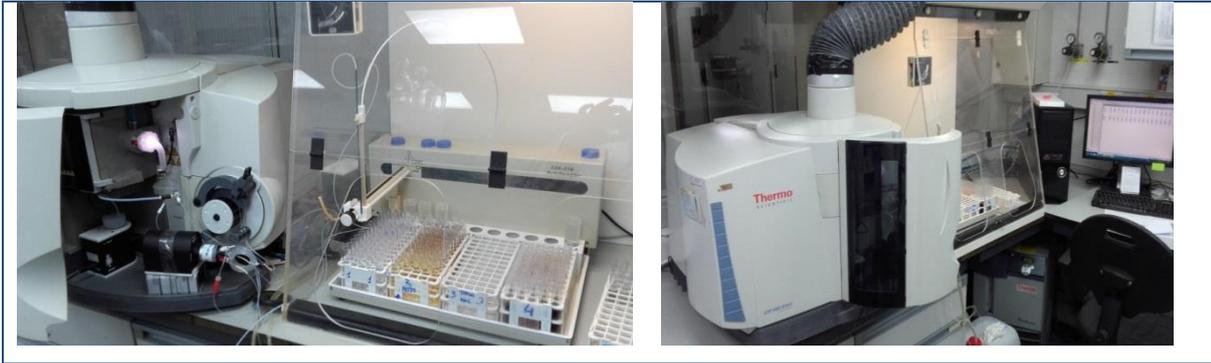
Figura 3.5.-Cromatógrafo ICAP 6500 DUO THERMO (ICP-OES)
