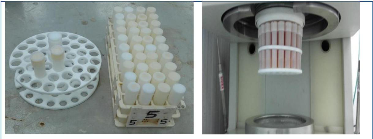
**Figura 3.4.**-Tubos de teflón. Reactor de Teflón ULTRACLAVE MLS
