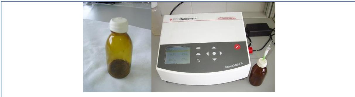
Figura 3.12.-Analizador de gas de espacio de cabeza electroquímico/infrarrojo
