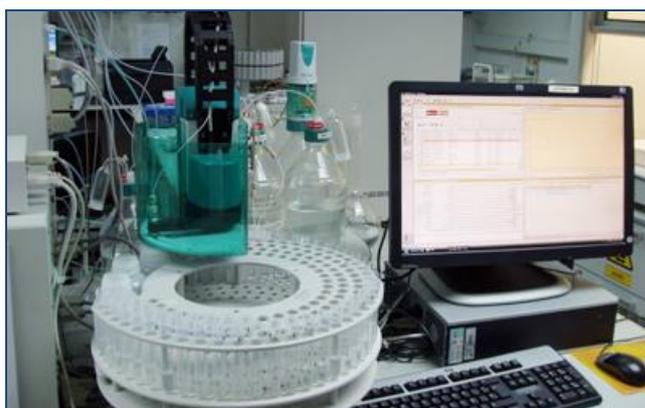
Figura 3.6.-Cromatógrafo iónico para la determinación de nitratos
