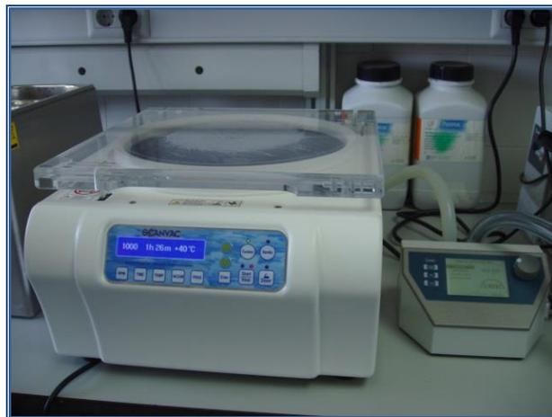
**Figura 3.15.**-Centrifuga de concentración a vacío
