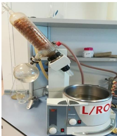
Figura 3.6. Rotavapor utilizado para evaporar el etanol de las muestras.
