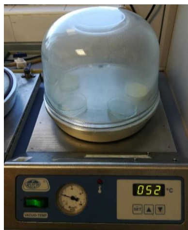
Figura 3.7. Desecador termostático a vacío (vacuo-temp) utilizado para evaporar el etanol de manera controlada.
