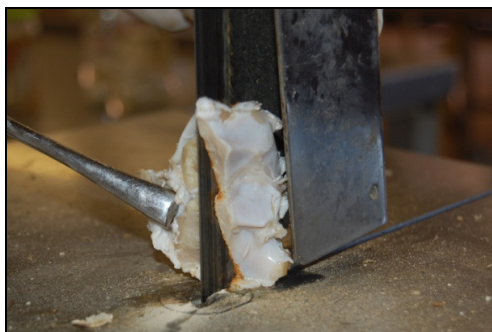
Fig. 10. Corte y preparación de la muestra para estudio estructural.
