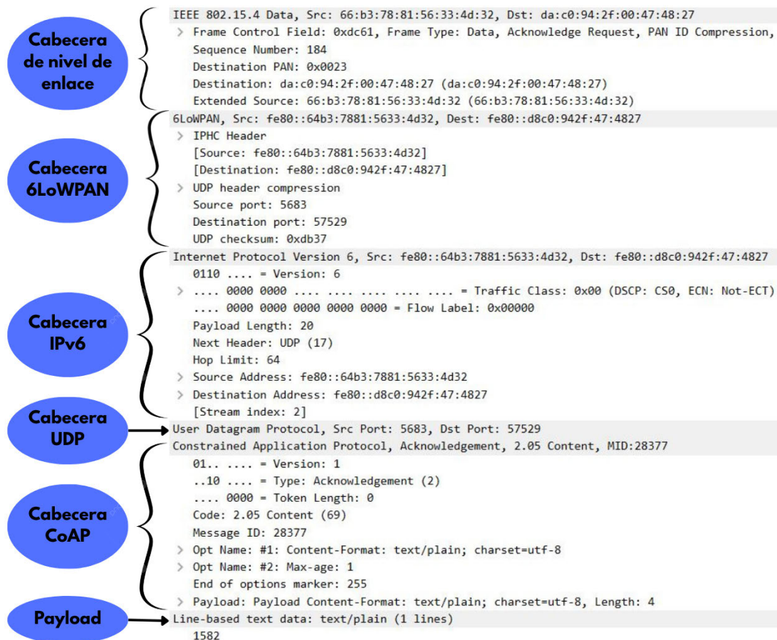
Figura 5.21: Contenido de una respuesta CoAP en el escenario entre dos motas IoT
