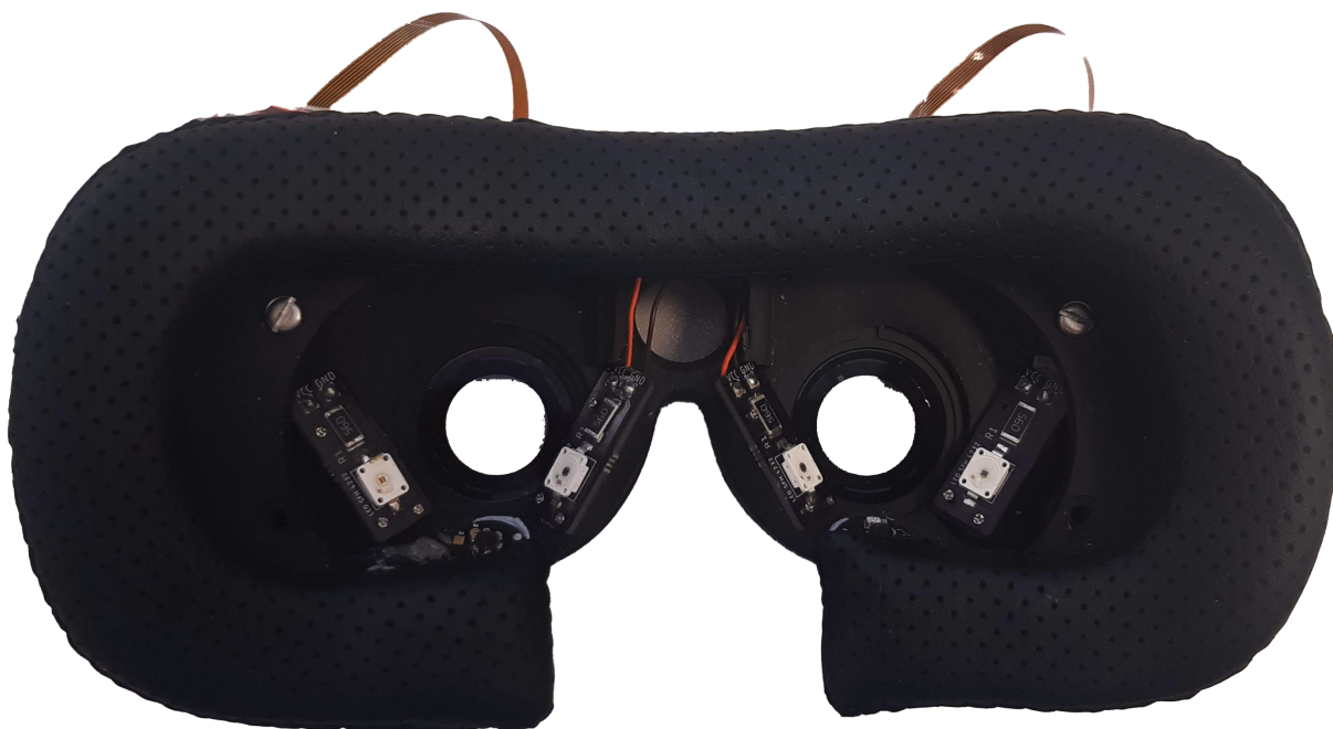
Figura 3.6: Imagen del prototipo de las gafas con todos los componentes montados.
